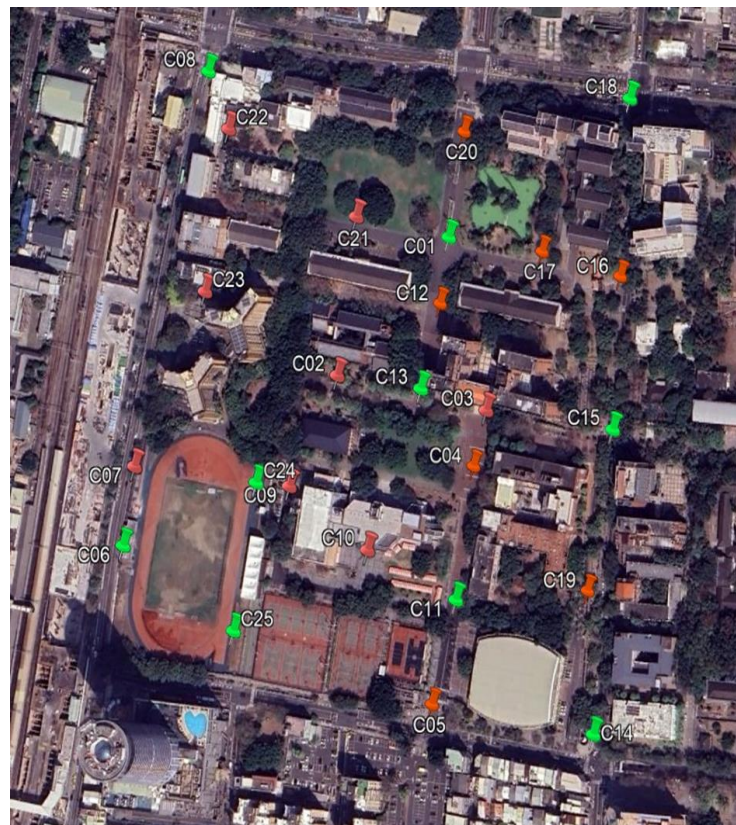
圖 8、空中三角測量所使用之控制點與檢核點分布圖。綠色標記為控制點，紅色標記為檢核點
